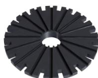
F型转子因叶轮沟槽以及外周齿轮的特殊设计，形成细小的气泡，其更大的叶轮尺寸在铝液中的弥散效果更佳。较薄的叶轮设计可以将熔体表面的波动控制在最小范围。
